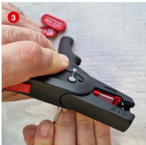
Установите инструмент на тонкую ровную поверхность. С помощью подходящей по диаметру отвертки аккуратно выдавите стальную ось.
