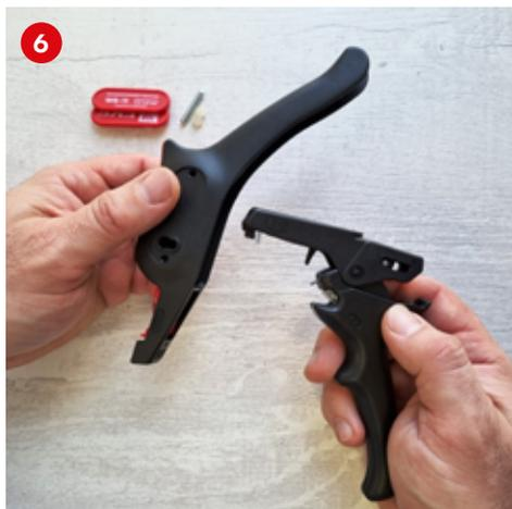
С помощью отвертки с крестовым шлицем открутите винт, фиксирующий верхнее лезвие. Произведите замену лезвия на новое. Зафиксируйте винт.
