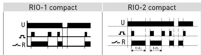
Реле RIO-1 compact не имеет функции памяти, т.е. при исчезновении питающего напряжения контакты размыкаются и после восстановления напряжения питания остаются в разомкнутом состоянии. Реле RIO-2 compact имеет функции памяти, т.е. при исчезновении питающего напряжения контакты размыкаются и после восстановления напряжения питания переходят в замкнутое состояние.
