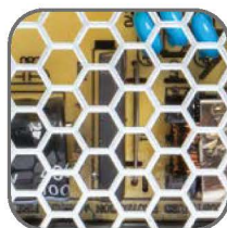
Вентиляционные отверстия для лучшего теплоотвода
