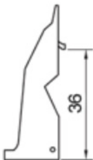
Рис. 5 Габаритные размеры держателя PM-22-36 EKF AVERES
